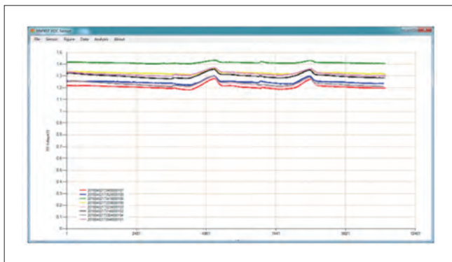
图9 冷藏室8℃情况下气味传感器输出的电压曲线图
