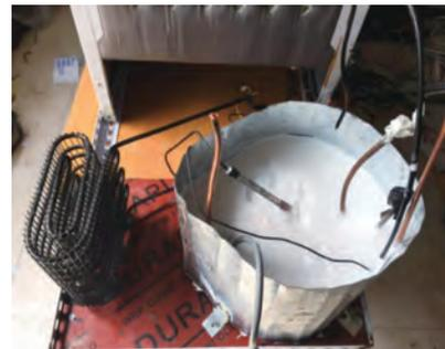
图10 相变蓄热包最终成型图
