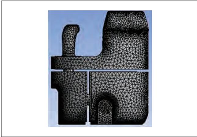
图8 改进后消声器网格模型
