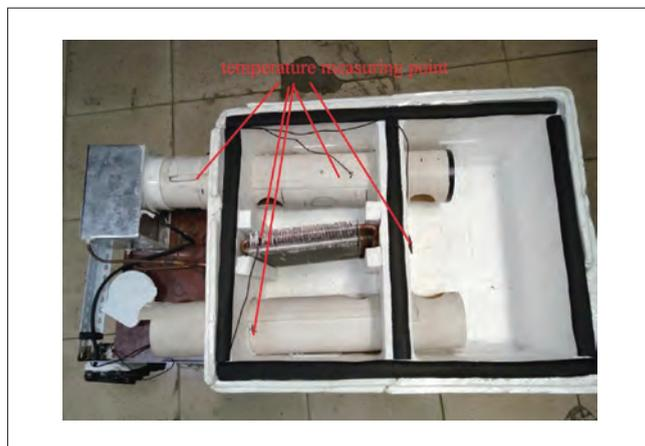
图6 冰箱的制冷系统温度测点
