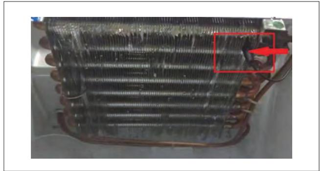
图2 蒸发器表面的温度测点
