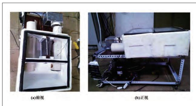
图4 自然风的风冷式冰箱除霜实验台
