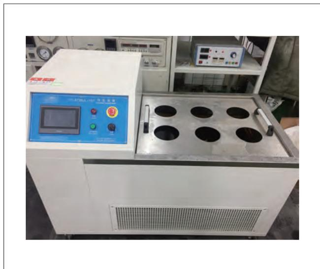
图2 恒温油槽
