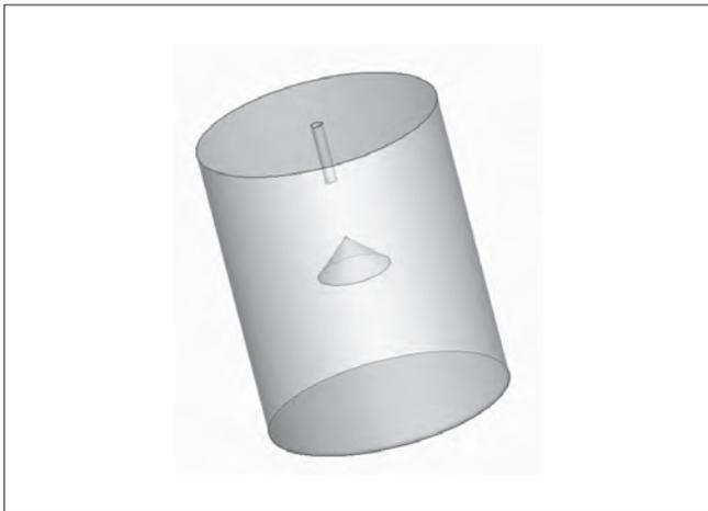
图1 受限射流计算区域模型图
