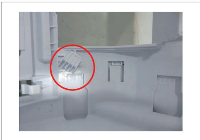
图1 卡扣断裂
