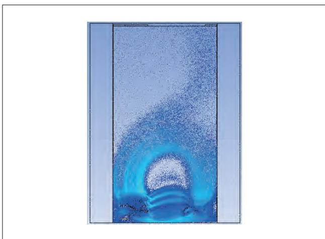
图6 整机箱体底部的速度矢量图
