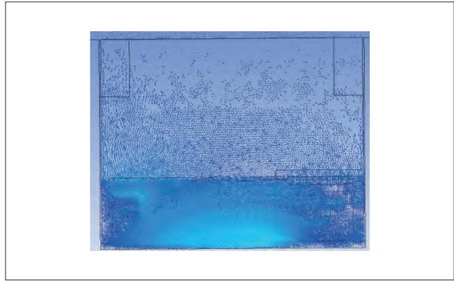
图7 整机箱体后部的速度矢量图
