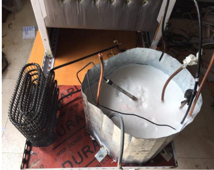
图 10 相变蓄热包最终成型图
