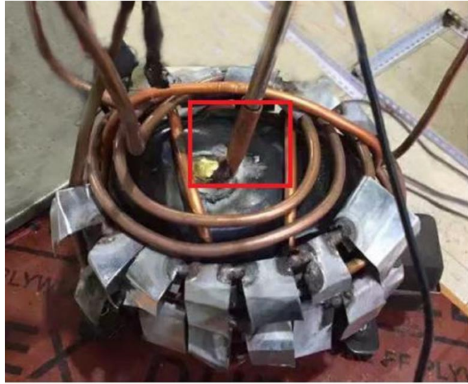
图5 压缩机壳体温度的测量点位置
