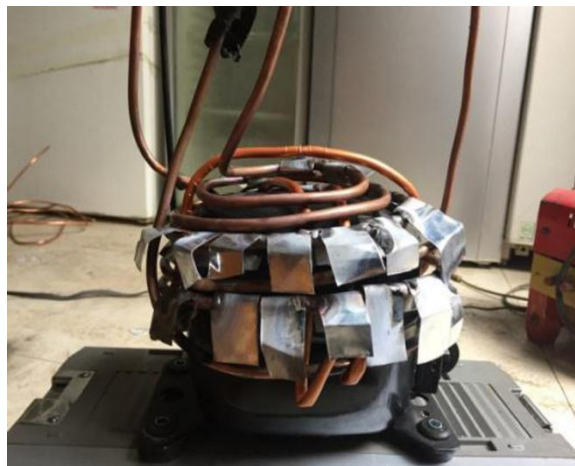
图 9 相变蓄热包的传热强化
