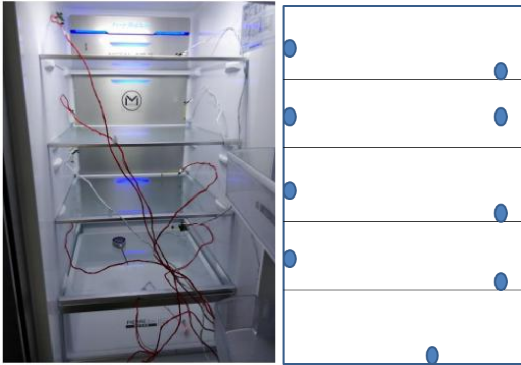
图 2 冰箱食品新鲜度检测模块安装示意图
