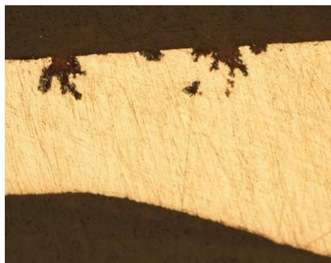
(a)蚁穴腐蚀铜管表面
