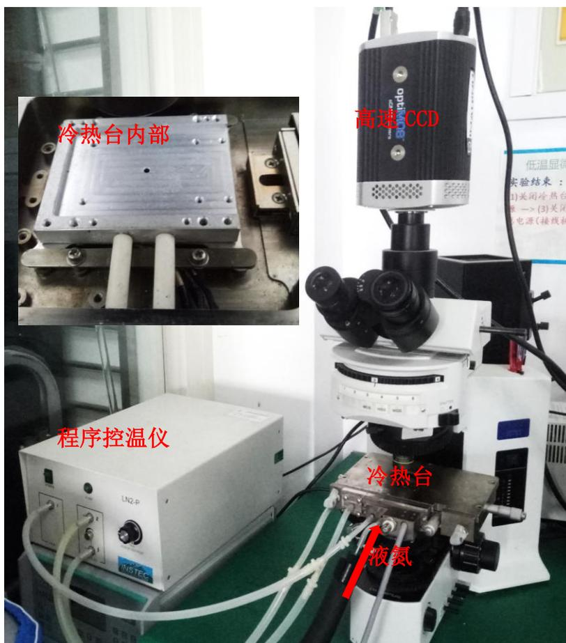
图 1 低温显微镜系统结构
