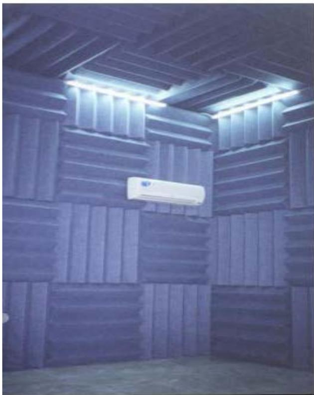
**静音室** (隔音房)是一种为有测试要求的产品制造车间设计的隔声测试装置，在隔声间内进行吸声处理，使其成为一个小型的无声室，在里面可测试一些小型的产品，如精密仪器、电机、变压器等。
