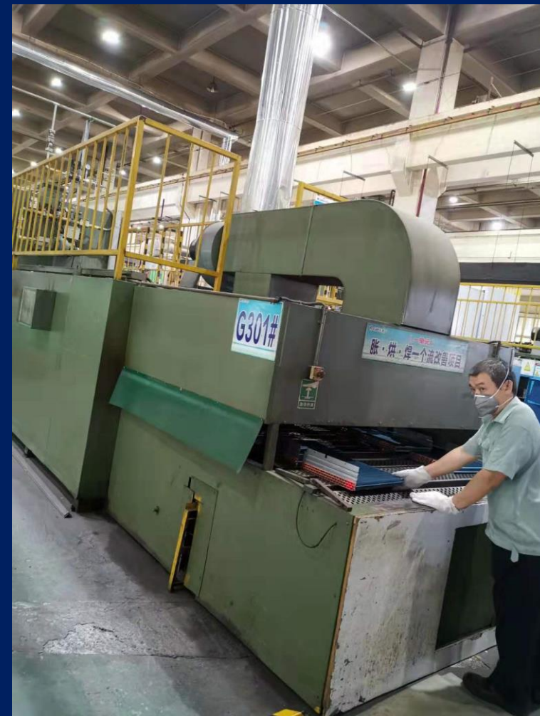
通过高温烘干，驱除加工过程 两器的润滑油残留
