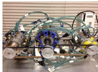
往复式样机和单向旋转阀样机
