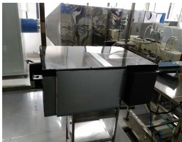
30立方米测试舱内测试的新风机样机
