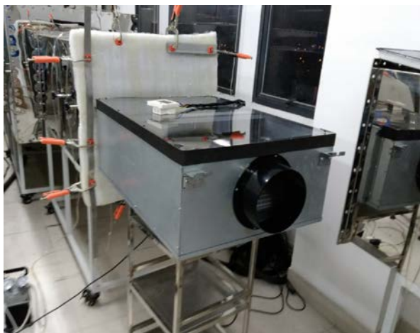
空气动力测试平台上的新风机样机
